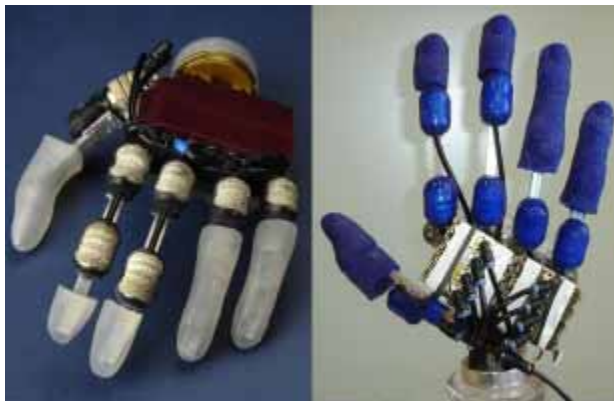
Bild 1 Ein Auszug an Prototypen der fluidisch angetriebenen Roboterhand.
