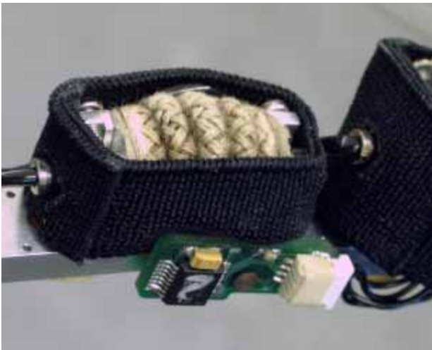
Bild 8 Ein Gelenk mit 12 mm Aktor und Winkelsensor.
